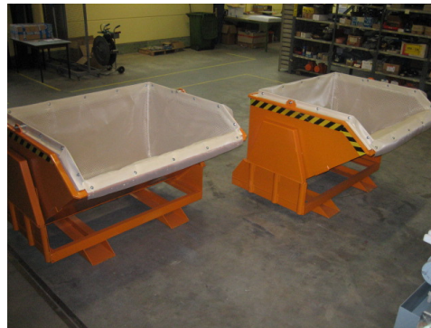
ECON container basculant permettant le vidange simple avec un chariot élévateur.
