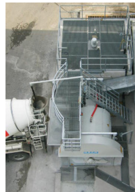
FLOTMAT-15-Kombi avec roue élévatrice à aube et table d'entrée.
