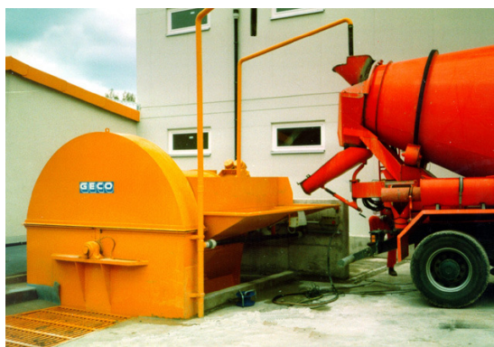
FLOTMAT-15-Kombi Table d'entrée pour 2 camion-malaxeurs et l'installation de lavage.
