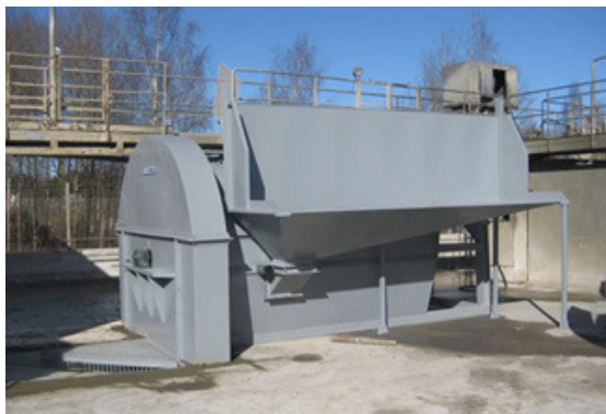
FLOTMAT-15-KOMBI avec grande table d'entrée pour 2 camions-malaxeurs et une pompe à béton.
