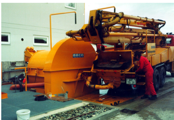
FLOTMAT-15-Kombi Roue élévatrice pour le nettoyage des pompes.
