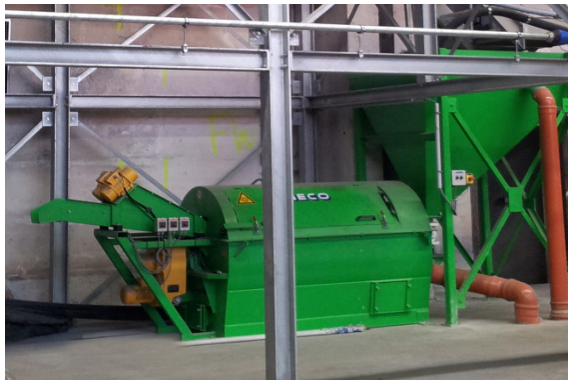
FLOTMAT-03-Vibro avec pré-séparateur et goulotte vibrante.
