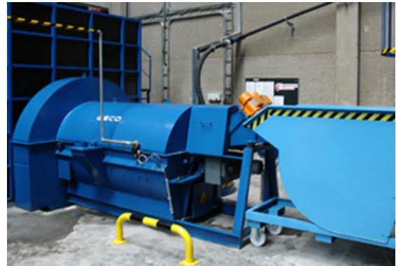
La galerie de drainage manutentionne du sable vers le conteneur sur roulettes.
